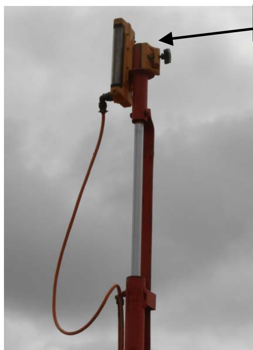
Sensor láser instalado en la trailla de la maquinaria
